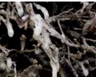
Gradierwerk der Saline Gottesgabe: Die Sole tröpfelt durch die Schwarzdornfüllung, zurück bleibt der Dornstein.
